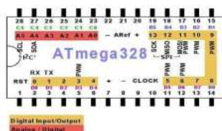
Fig1 (Arduino ATmega328 Pinout)
