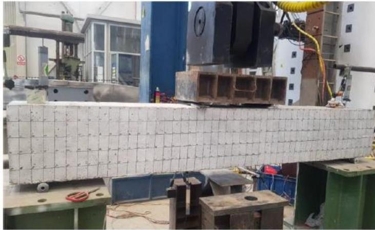
**Fig. 6.** fatigue test setup
