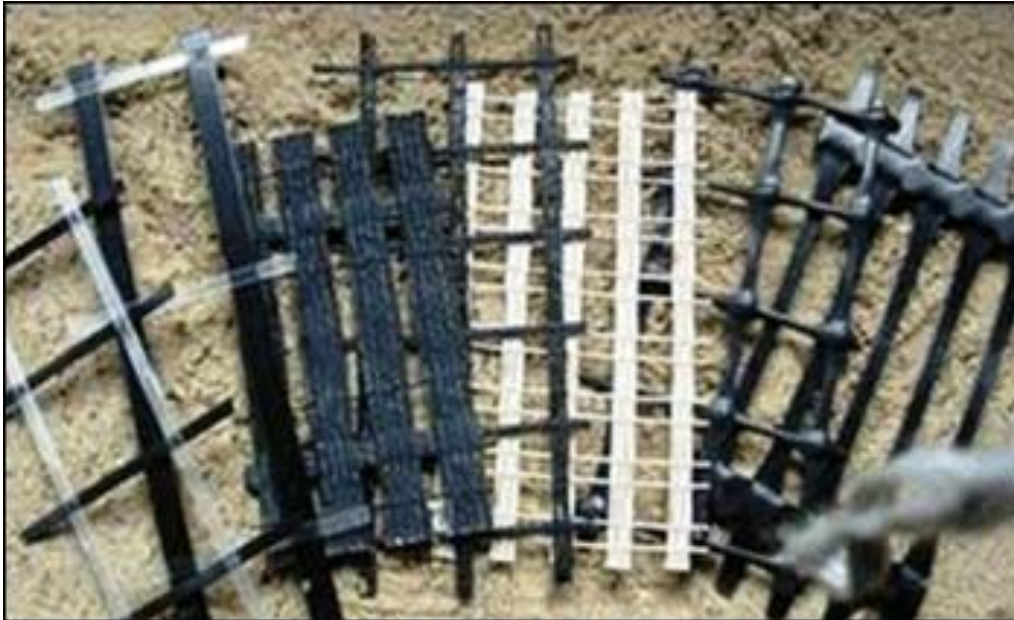
Fig. 1: Uniaxial PE or PP Geogrids
