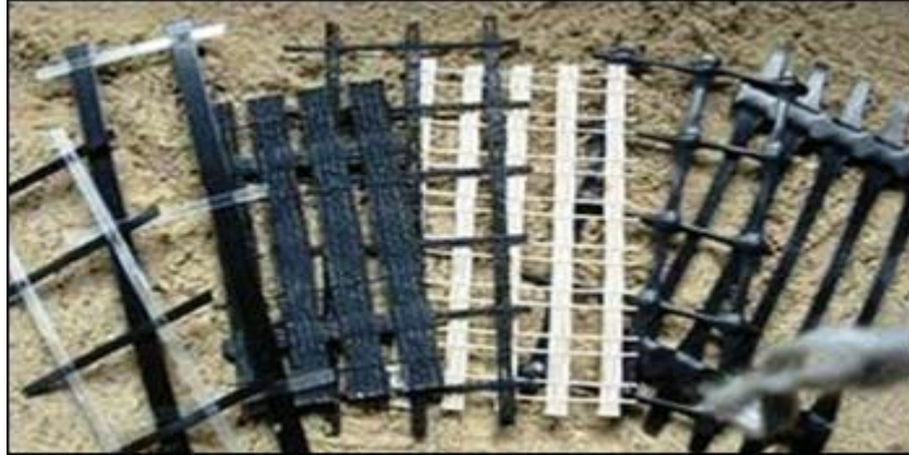
Fig. 1: Uniaxial PE or PP Geogrids
